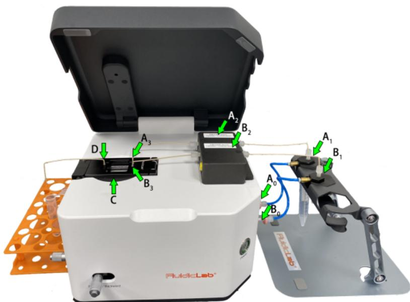
① 用气管依次连接“空气压缩机”--“气源处理装置”--“微滴/微球制备仪”；
